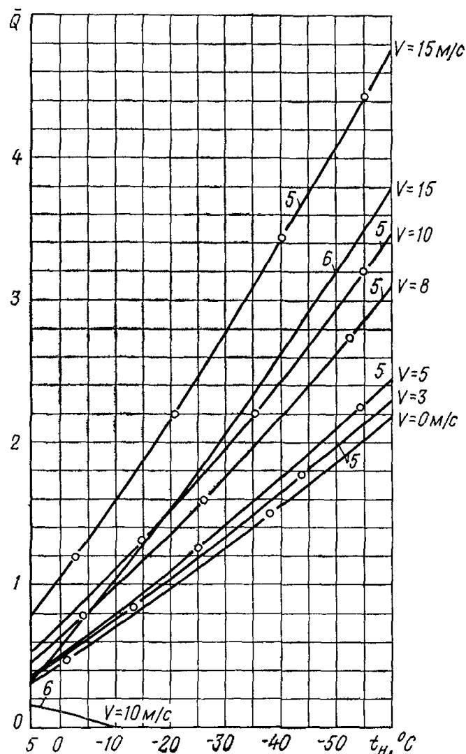
Рис. 6. Величина относительных теплопотерь ( $\bar{Q}$ ) для помещений 5—6-го этажей шестиэтажного здания с вытяжной вентиляцией, не компенсируемой притоком в рабочее время
