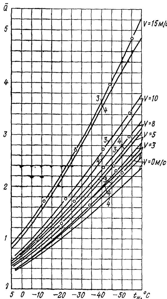
Рис 5 Величина относительных теплопотерь ( $\bar{Q}$ ) для помещений 3–4-го этажей шестистороннего здания с вытяжной вентиляцией, не компенсируемой притоком в рабочее время
