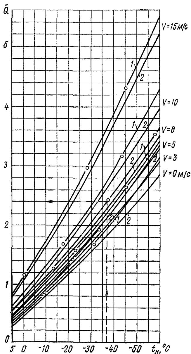
Рис. 4. Величина относительных теплопотерь ( $\bar{Q}$ ) для помещений 1—2-го этажей шестиэтажного здания с вытяжной вентиляцией, не компенсируемой притоком в рабочее время
