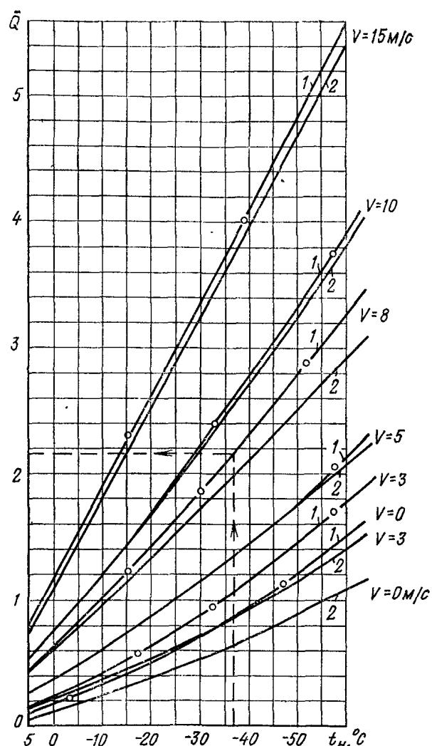
Рис. 1. Величина относительных теплопотерь ( $\bar{Q}$ ) для помещений 1—2-го этажей шестистороннего здания в нерабочее время, а также для помещений с вытяжной вентиляцией, полностью компенсируемой притоком в рабочее время
