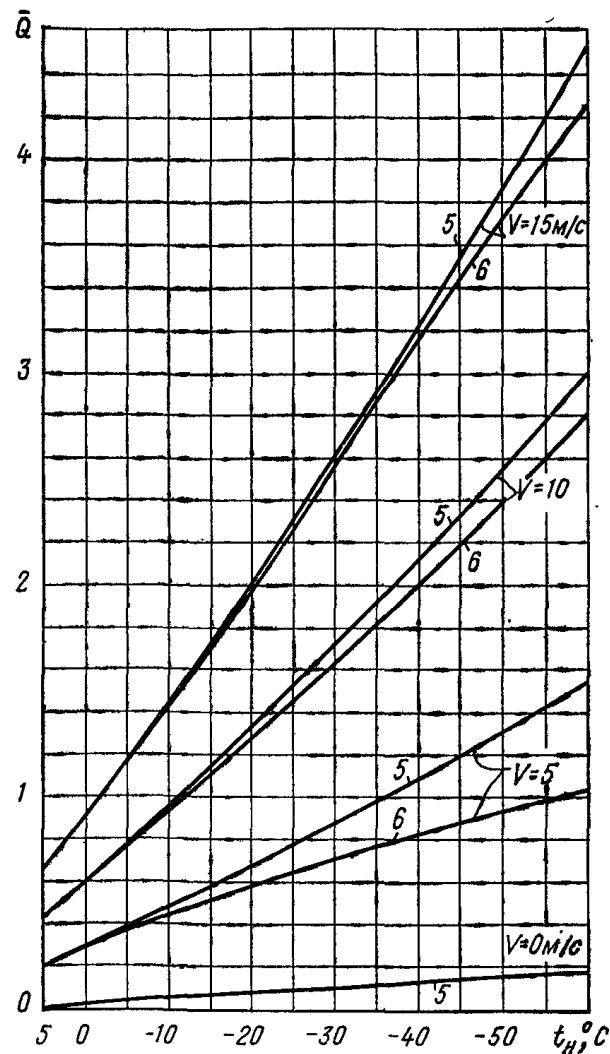
Рис. 11. Величина относительных теплопотерь ( $\bar{Q}$ ) для помещений 5—6-го этажей девятиэтажного здания при выключенной системе вентиляции
