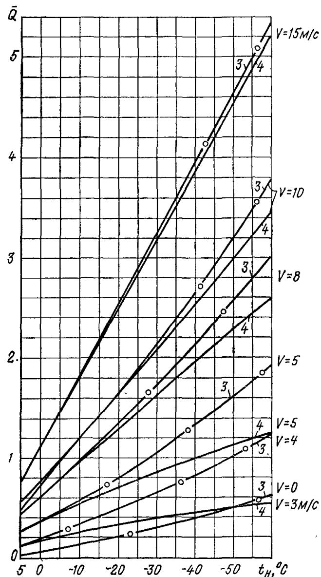
Рис. 2. Величина относительных теплопотерь ( $\bar{Q}$ ) для помещений 3—4-го этажей шестиэтажного здания в нерабочее время, а также для помещений с вытяжной вентиляцией, полностью компенсируемой притоком в рабочее время
