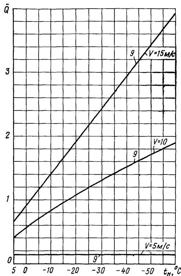
Рис. 13 Величина относительных теплопотерь ( $\bar{Q}$ ) для помещений 9-го этажа девятиэтажного здания при выключенной системе вентиляции
