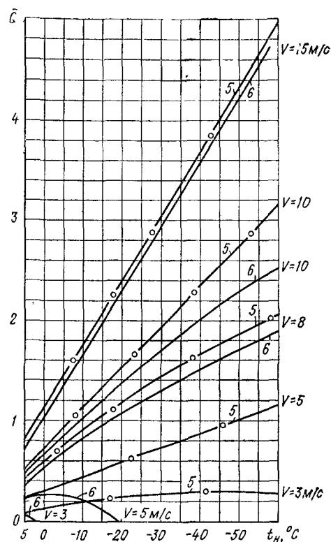
Рис. 3. Величина относительных теплопотерь ( $\bar{Q}$ ) для помещений 5—6-го этажей шестиэтажного здания в нерабочее время, а также для помещений с вытяжной вентиляцией, полностью компенсируемой притоком в рабочее время
