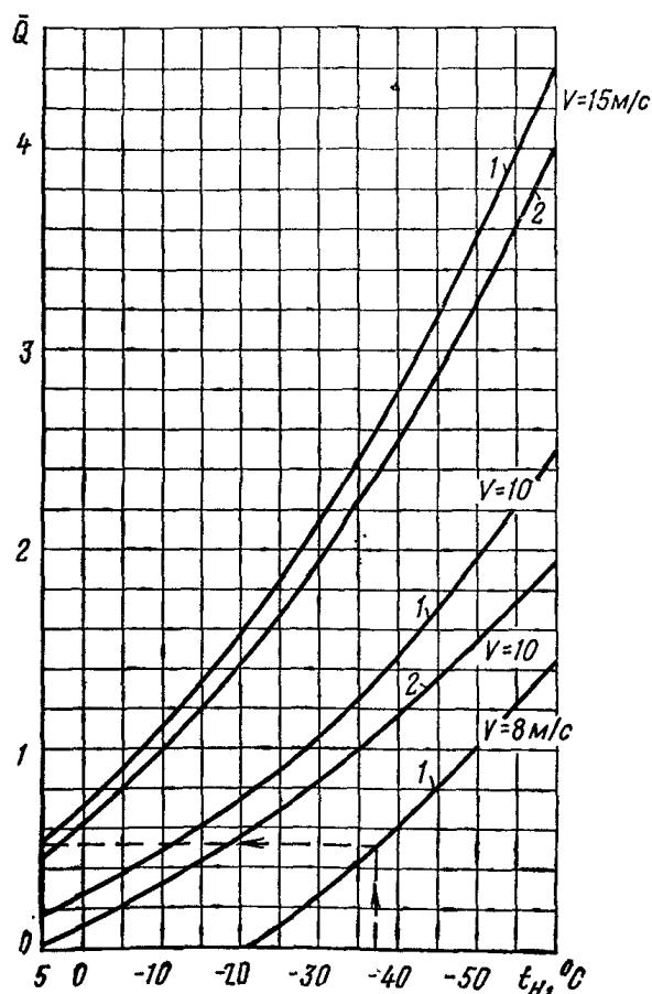
Рис. 7. Величина относительных теплопотерь ( $\bar{Q}$ ) для помещений 1—2-го этажей шестиэтажного здания с избыточным притоком в рабочее время
